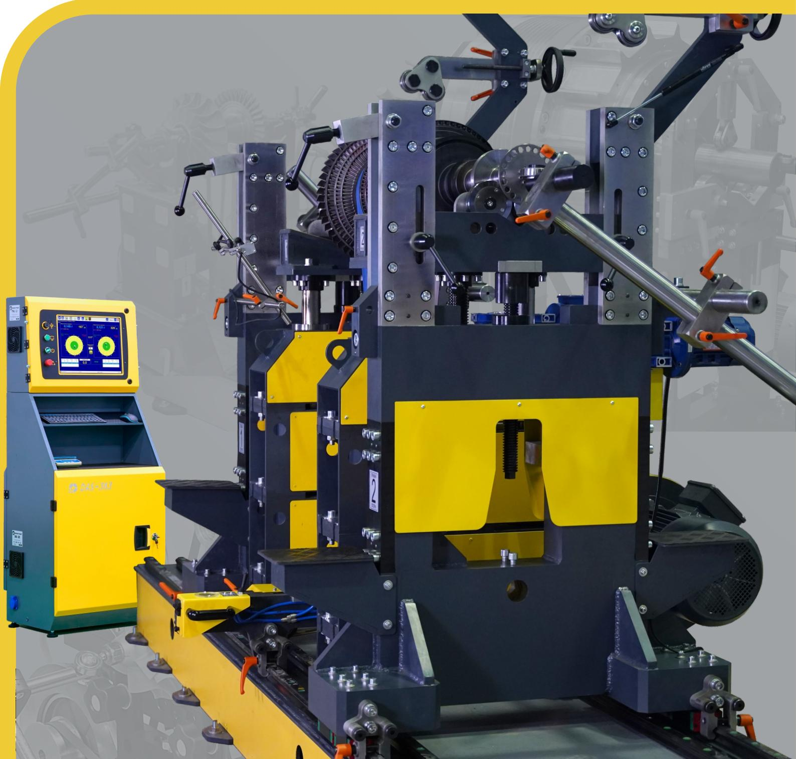
Широкоуниверсальные балансировочные станки с горизонтальной осью вращения серии БС-44-20000 предназначены для динамической балансировки таких деталей как крупногабаритные якори электродвигателей, вентиляторы, центрифуги, насосы, колесные пары поездов, текстильные валы, турбины, резиновые прижимные валы, центробежные рабочие колеса, сушильные цилиндры, а также практически любых роторов, узлов и деталей, проходящих по массе и габаритам.
