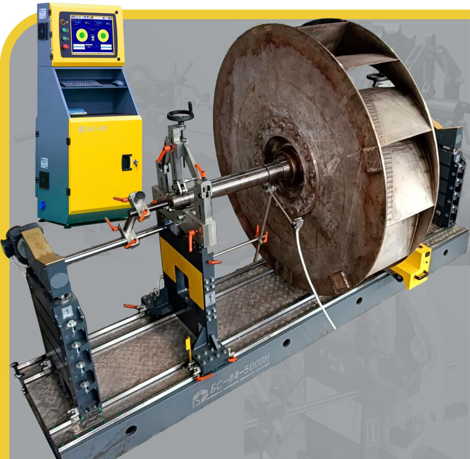
Широкоуниверсальные балансировочные станки с горизонтальной осью вращения серии БС-44-5000 предназначены для динамической балансировки таких деталей как якори электродвигателей, насосы, вентиляторы, турбины, текстильные валы, колесные пары поездов, шпинделы, центрифуги, резиновые прижимные валы, а также практически любых роторов, узлов и деталей, проходящих по массе и габаритам.
