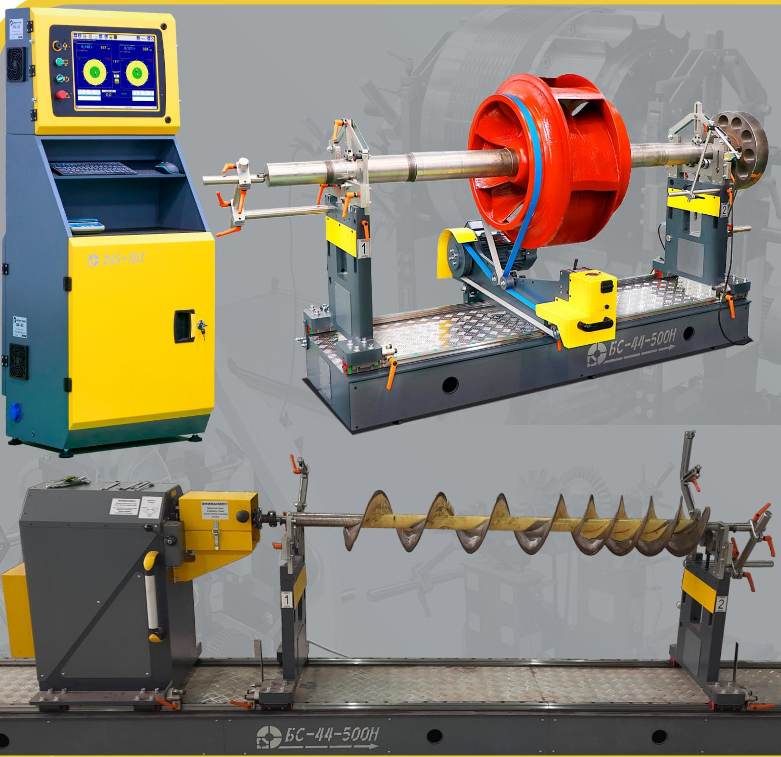
Широкоуниверсальные балансировочные станки с горизонтальной осью вращения серии БС-44-500 предназначены для динамической балансировки таких деталей как насосы, центрифуги, якори электродвигателей, измельчители, шнеки, турбины, вентиляторы, валы машин, шлифовальные круги, а также практически любых роторов, узлов и деталей, проходящих по массе и габаритам.
