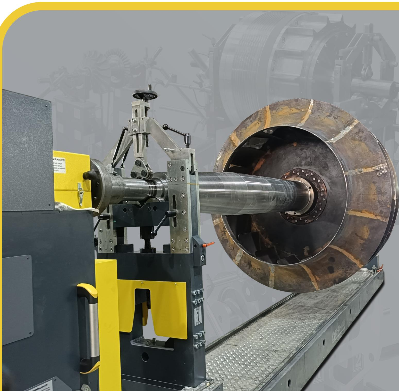
Широкоуниверсальные балансировочные станки с горизонтальной осью вращения серии БС-44-8000 предназначены для динамической балансировки таких деталей как крупногабаритные якори электродвигателей, вентиляторы, центрифуги, насосы, колесные пары поездов, текстильные валы, турбины, резиновые прижимные валы, центробежные рабочие колеса, сушильные цилиндры, а также практически любых роторов, узлов и деталей, проходящих по массе и габаритам.
