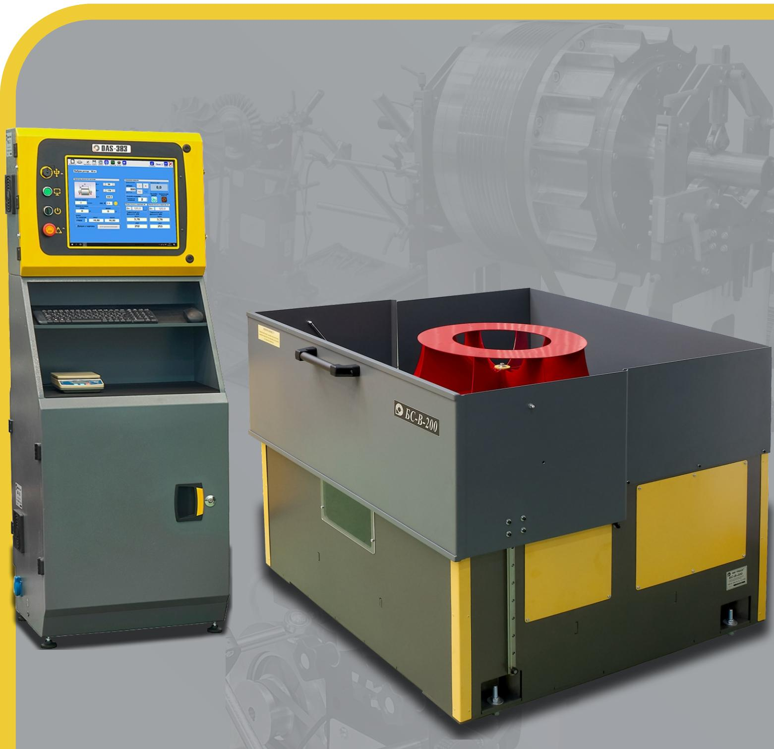
Балансировочные станки с вертикальной осью вращения серии БС-В-(60/200/600) предназначены для динамической балансировки деталей не имеющих собственных шеек вала, например, режущий инструмент металлообрабатывающих станков, детали в виде дисков, колес.
